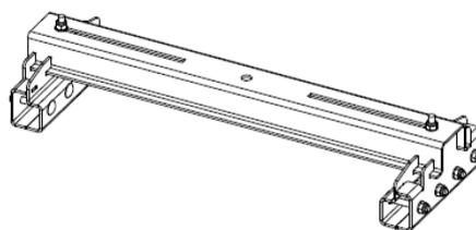
Stehfalzanker Easy: Bahnbreiten bis 670mm
